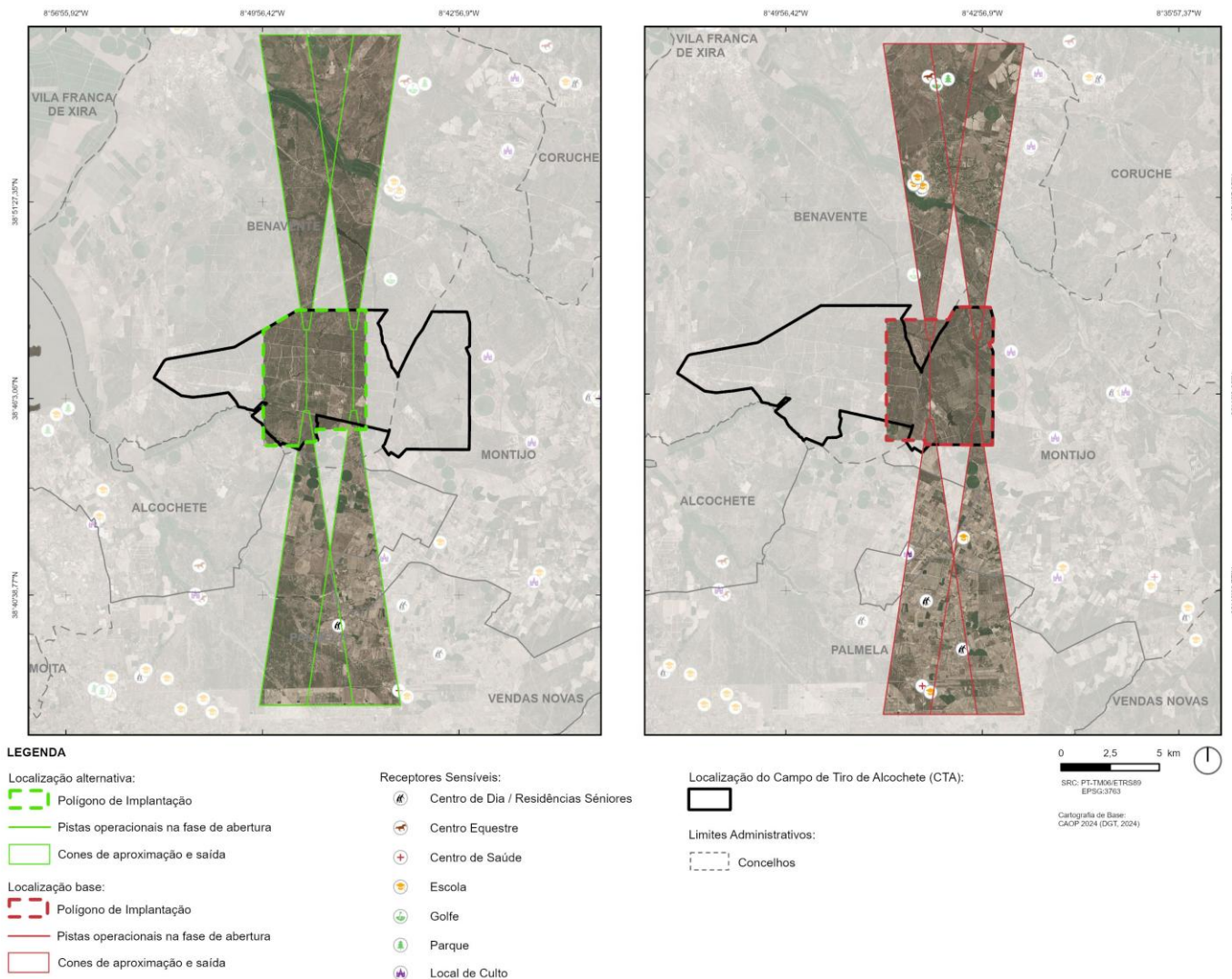
Figura 30 – Recetores sensíveis afetados pelos cones de aproximação e saída das localizações
